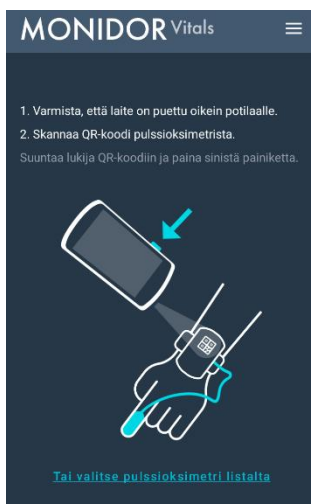
Bild 2: Anslut den trådlösa patientmonitorn till pulsoximetern genom att skanna pulsoximeterens QR-kod.
